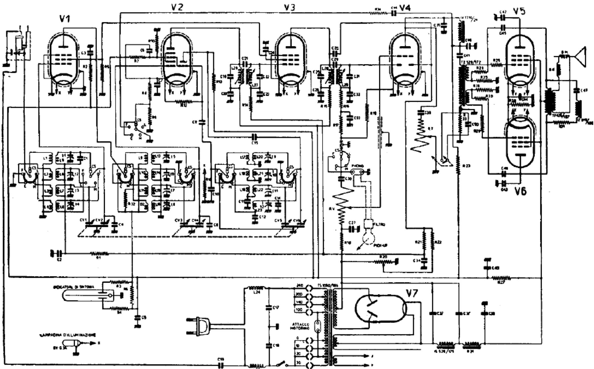
**PHONOLA (S. A. FIMI).** — Mod. « 715 e 716 ». — Schema elettrico. (I valori delle capacità e delle resistenze si trovano a pagina seguente). — Valvole: V1 = EF9; V2 = ECH8; V3 = EF9; V4 = EBC3; V5 = EL8; V6 = EL3; V7 = WE58.
